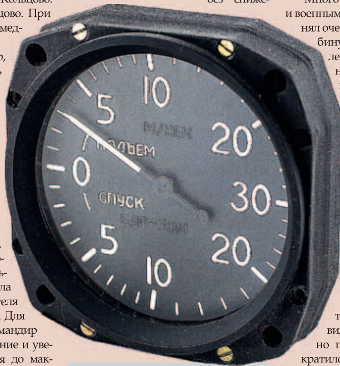
▲ Указатель вертикальной скорости вариометр
